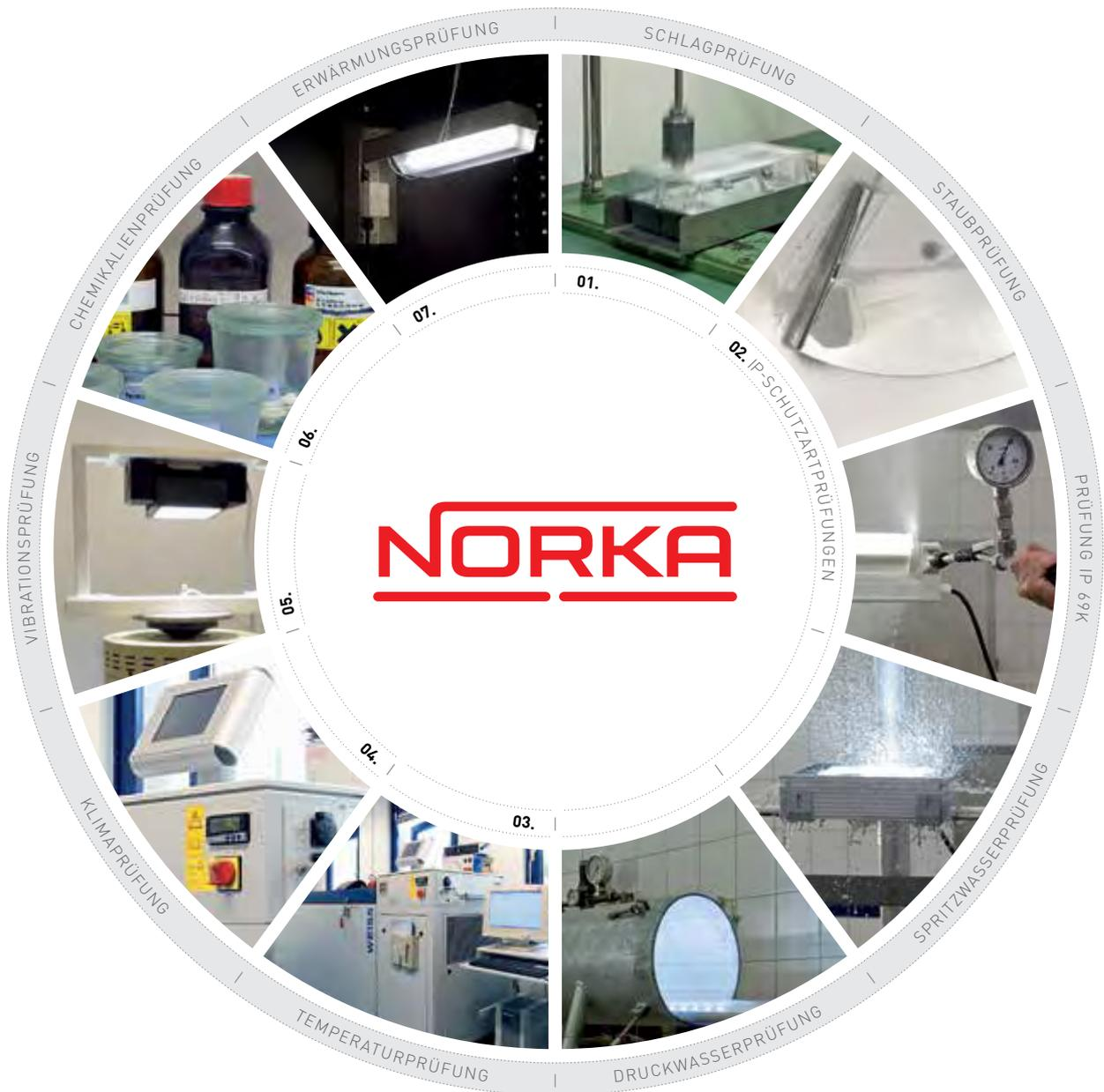
**01. SCHLAGPRÜFUNG:** Bei Schlagprüfungen nach DIN EN 50102 wird mittels Feder- oder Fallhammer die maximale mechanische Beanspruchung von Materialien getestet.
