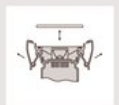
Spezielles Clip-Systemdesign garantiert gute Abdichtung und einfache Wartung
