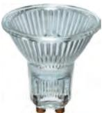
Spannung 230Volt, Ø 50,7mm, Sockel GZ10 und GU10, Aluminiumbeschichtung zur Vermeidung von rückwärtigem Wärmestau, mit eingebauter Sicherung, UV-Block
