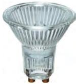
Spannung 230Volt, Ø 51,0mm, Länge 51,0mm, Sockel GU10, 30% Energieeinsparung, Niedervolt-Halogenlampe mit Aluminiumbeschichtung, UV-Block
