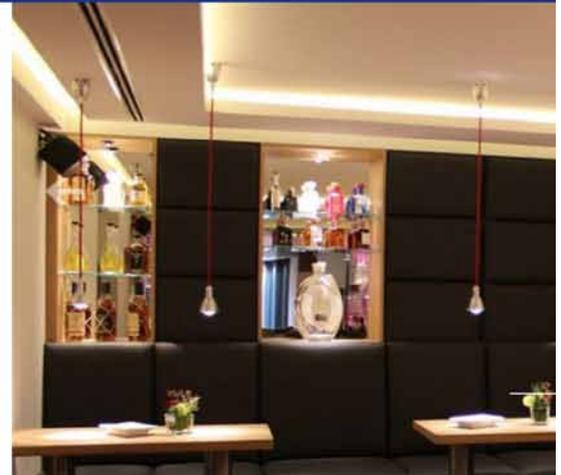
Vouten Beleuchtung für ein sanftes Licht entsteht aus der Architektur des Raumes heraus. Hierbei wird die Form der Decke oder Wand mit energieeffizienten LED-Lichtleisten oder Flexbändern wirksam herausgearbeitet.
