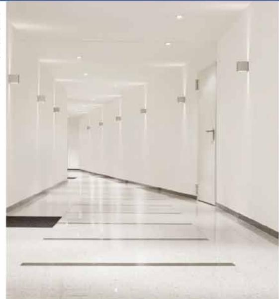
Wandleuchte mit optischer Linse, randscharfe Abbildung der engen Lichtkegel zur Rhythmisierung der Architektur
