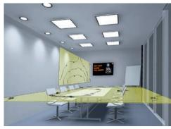
Am Auge des Nutzers werden ca. 450 Lux erreicht. Optimale Unterstützung des biologischen Systems bei Nutzern mittleren Alters.
